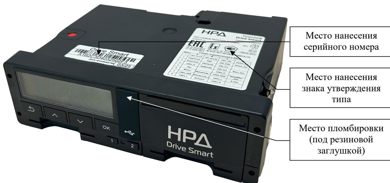
Рисунок 2 – Общий вид тахографов, выпускаемых под товарным знаком «HPD»
